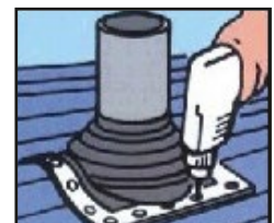
5. Dektite® mit JT 3 Edelstahl-Bohrschrauben oder Bulbrite-Nieten befestigen. Zusätzliche Sicherung durch Rohrschelle möglich.
