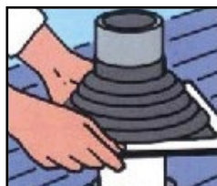
2. Dektite® an Profilblech anpassen und markieren
