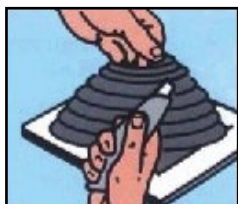
1. Dektite® an Rohr anpassen
