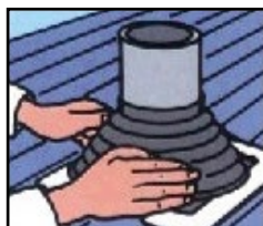
3. Dektite® formgenau an Profilblech anpassen
